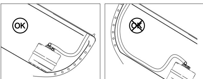
Bei der Montage berücksichtigen, dass der Füllschlauch immer an derselben Bordseite montiert werden muss wie der Tank.
