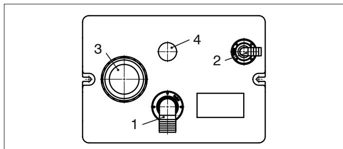
En caso de necesitar más conexiones de llenado deberá practicar orificios adicionales (ø 43 mm) para los conectores adicionales.
