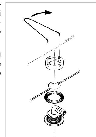
Per prevenire problemi di intasamento, soprattutto a causa di capelli o sporcizia più grossa, è necessario che tutti i raccordi siano scevri di residui di foratura, che i ristringimenti siano ridotti al minimo e che i passaggi da un diametro all'altro siano muniti di raccordi conici o di ampio raggio.
