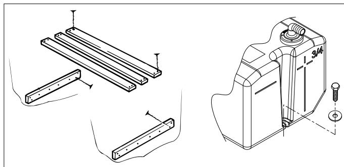
Prévoir un socle suffisamment solide pour installer le réservoir et le fixer correctement.
