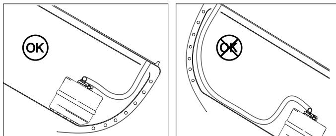
Nel montaggio tenete conto del fatto che il tubo di riempimento deve trovarsi sempre dallo stesso lato del serbatoio, rispetto alla linea mediana dell'imbarcazione.
