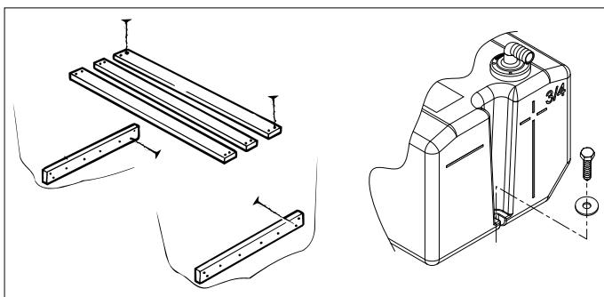
Asegúrese de que exista una base lo suficientemente sólida para colocar y fijar el tanque de manera firme.
