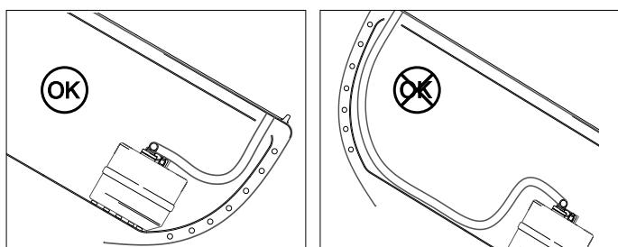
Houd rekening bij het monteren, dat de vulslang te allen tijde aan dezelfde boordzijde gemonteerd dient te worden als de tank.
