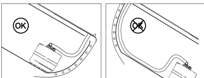
Cuando realice las conexiones, recuerde que el tubo de llenado siempre debe estar colocado del mismo lado de la embarcación en el que está el tanque.
