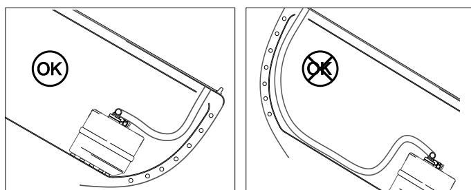
Lors du montage tenir compte du fait que le tuyau de remplissage doit être placé du même côté du bateau que le réservoir.
