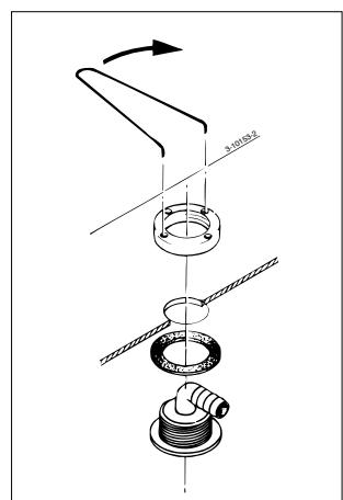
Um Verstopfungen, insbesondere durch Haare und groben Schmutz vorzubeugen, müssen alle Fittingen innen sorgfältig entgratet werden, alle Verengungen auf ein Minimum begrenzt bleiben und Übergänge zu anderen Querschnitten mit konischen Übergangsstücken oder großen Radien ausgeführt werden.
