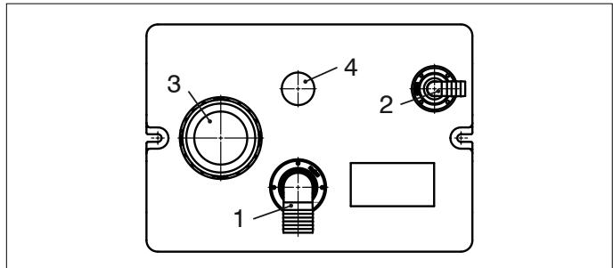
Eventuell zusätzliche Löcher für extra Fittinge (ø 43 mm) anbringen, falls mehrere Zulaufanschlüsse erforderlich sind. Die Fittinge so anbringen, dass bei einer Seitenlage des Schiffes vermieden wird, dass verunreinigtes Wasser aus dem Schmutzwassertank zurück zur Toilette oder über die Tankentlüftung nach draußen fließen kann.
