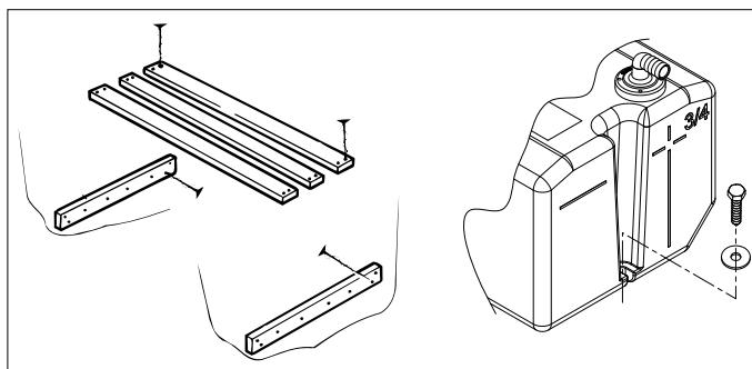
Assicuratevi che il fondamento su cui poggia il serbatoio sia sufficientemente resistente per sostenere e fissare il serbatoio stesso.
