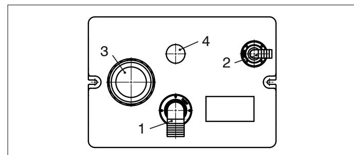
Des trous supplémentaires peuvent être percés pour installer des raccords supplémentaires (ø 43 mm) si davantage de tuyaux d'arrivée sont nécessaires.
